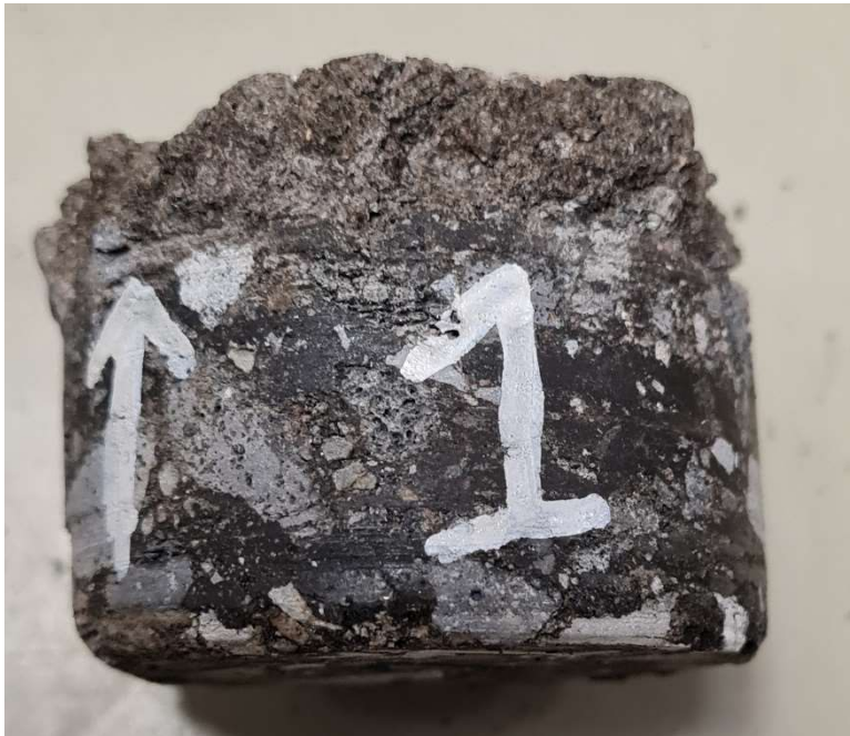
Mynd 1. Sýni 1. Kaldblandað malbik. Sýnið er 50,9 mm í þvermál og um 38,5 mm á hæð. Yfirborð sýnisins er skemmt. Örin vísar til yfirborðs.
